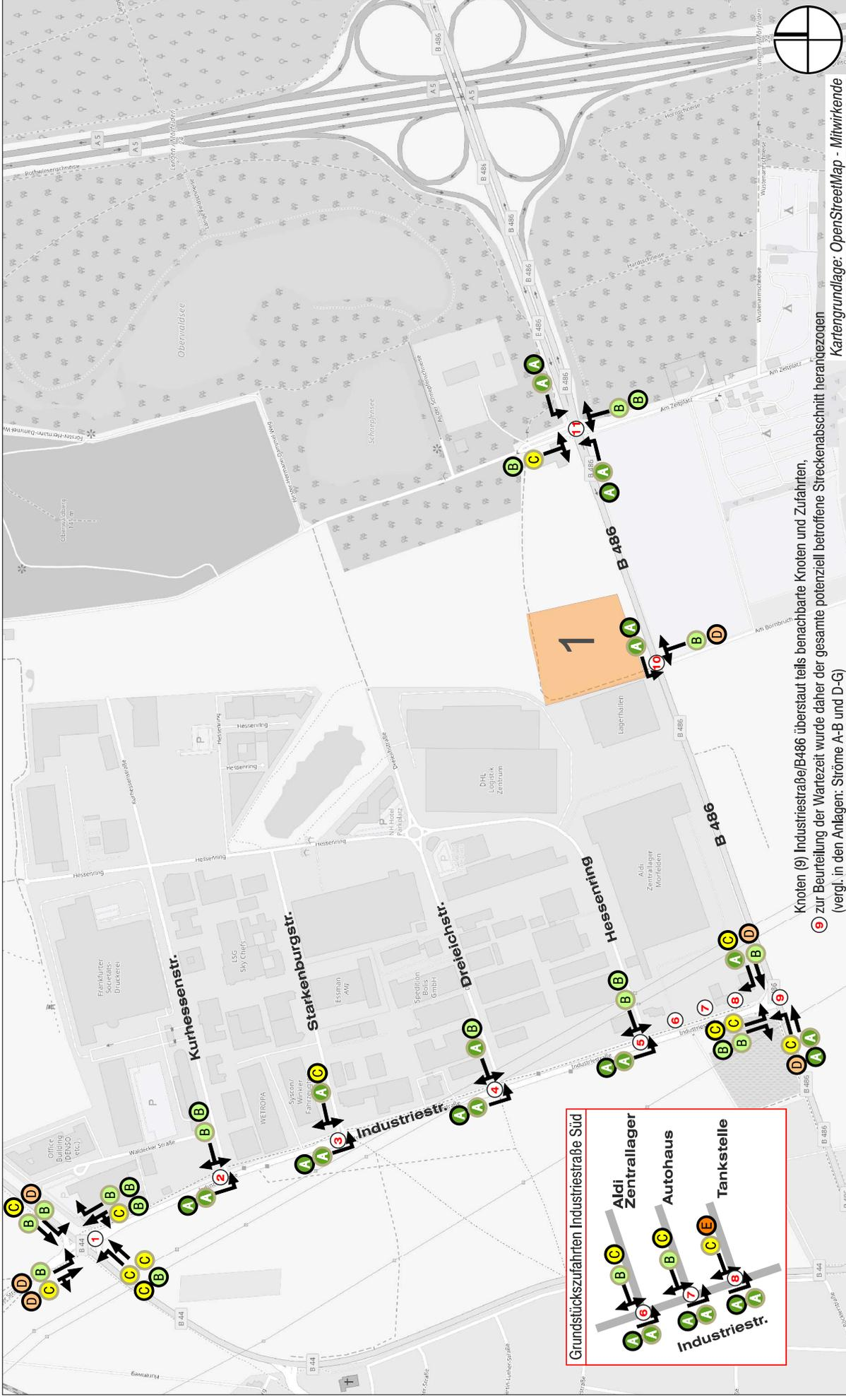
Knoten (9) Industriest. überstaut teils benachbarte Knoten und Zufahrten, (B) zur Beurteilung der Wartezeit wurde daher der gesamte potenziell betroffene Streckenabschnitt herangezogen (vergl. in den Anlagen: Ströme A-B und D-G)
