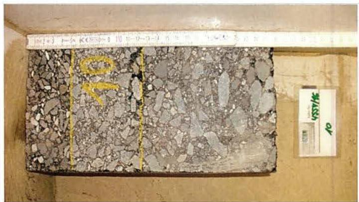
Abbildung 2: Asphaltaufbau des Bohrkerns der Entnahmestelle 10
